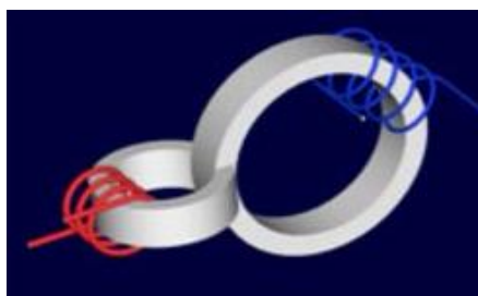
Slika 2. Dva namota sa efektom prividnog zračnog raspora
